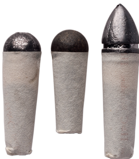
Fra venstre: to rundkulepatroner i forskjellig lengde og spisskulepatron laget med kule fra original kuletang.
